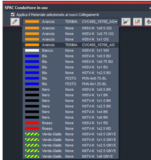
Facendo tasto destro sulla lista dei conduttori è possibile cambiare i conduttori visualizzati e modificarne l'ordinamento e i filtri
